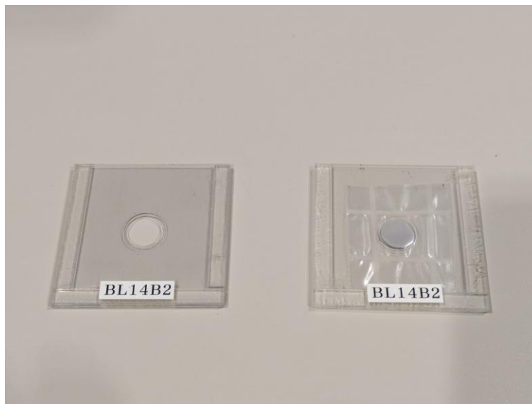
(左)試料ケース本体、(右)試料を固定した状態
