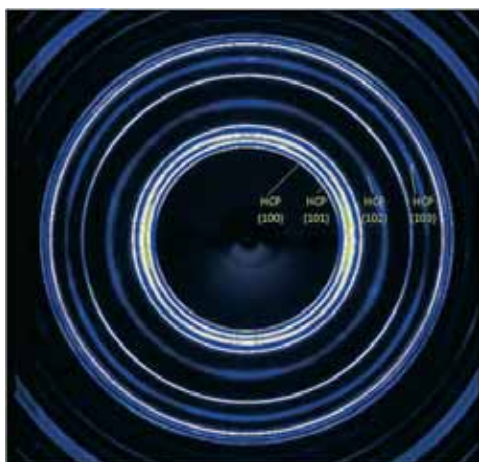
Fig.1 引っ張りひずみを加えた形状記憶合金のデバイリング
