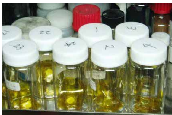
図 1. 測定に用いた試料。BN で希釈した後, ペレット状に成型し, カプトンシートにより封入した。カプトンシートの接着には, アピエゾングリスを用いた。
