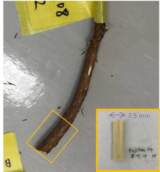
図 1 試料片を採取した萌芽子と試料片例 (右下)。萌芽子の橙色四角で囲まれた部位を幅約 7.5 mm 厚さ 1.0 mm 程度の薄板状に加工して試料片とした。
