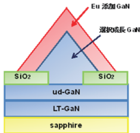
図 1. 選択成長 GaN 上に成長した Eu 添加 GaN の模式図
