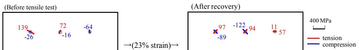
図4. 引張変形前試料の各測定位置の主応力(MPa)、および引張変形後に加熱形状回復した試料の主応力。線方向が主応力方向を表し、その長さが応力値を表している。図中の数値は赤字が引張応力、青字が圧縮応力の値を表す。
