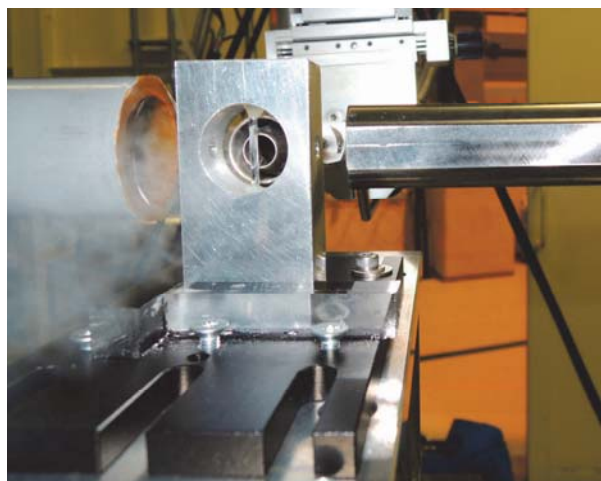
図 1. BL19B2 に設置した低温測定用キャピラリーセル。画面右の最終スリットより X 線が照射される。
