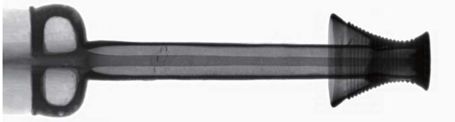
図 2. 柄内部が中空構造をもつバイメタル剣(大原 6632)の外観(上)と X 線イメージング図像(下)
