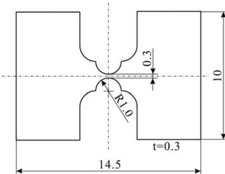
図 1. 試験片形状および寸法
