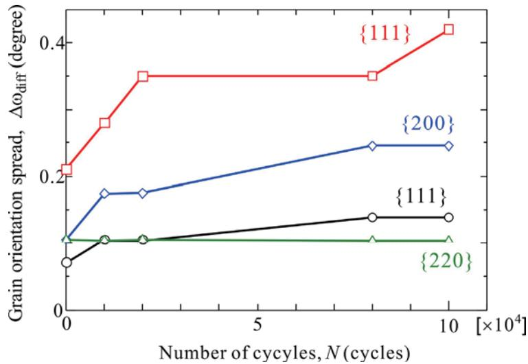
図 4. 同一結晶粒における回折面からの回折スポットの回折の拡がり角の変化
