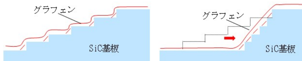
図 5. (a)従来の Si 面上グラフェンと(b)今回の Si 面上グラフェンのグラフェン形成模式図
