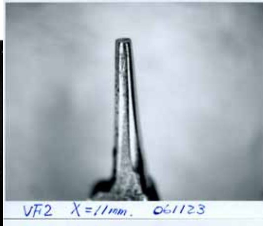
図-1 測定用試料の SCC 割れ（光学顕微鏡像）と測定用試料の外観
